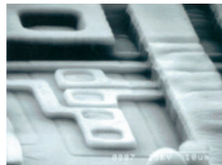
상위 레이저 제거 후의 IC 표면 SEM 사진
